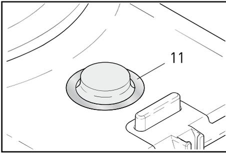
Je nach Art des Füllgutes kann ein Wechsel erforderlich sein, ohne dass die Filtertüte bis oben gefüllt ist. Die Filteranzeige erscheint nicht bei niedriger Saugkrasteinstellung. Sie sollte regelmäßig bei hoher Saugkraft überprüft werden.
