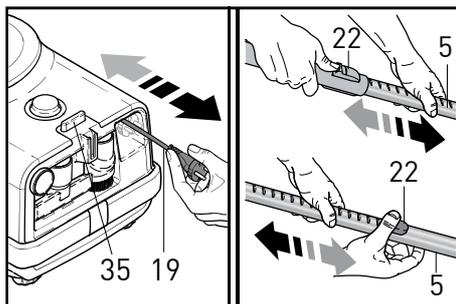
Das Teleskoprohr (5) sollte vor Arbeitsbeginn auf die gewünschte Arbeitshöhe eingestellt werden. Betätigen Sie dazu die Schiebetaste (22).
